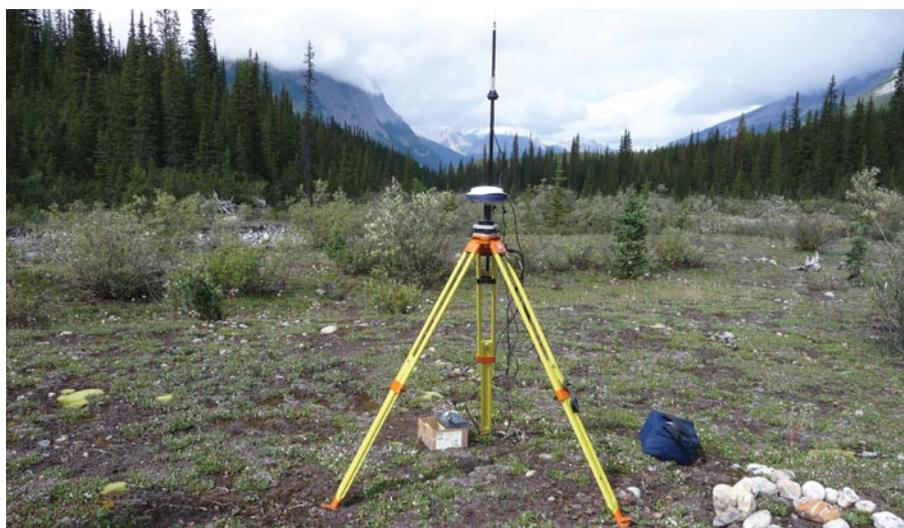
Figure 2. Positionnement GPS autonome de précision et GPS cinématique en temps réel pour l'arpentage officiel — Parc national de Banff.
