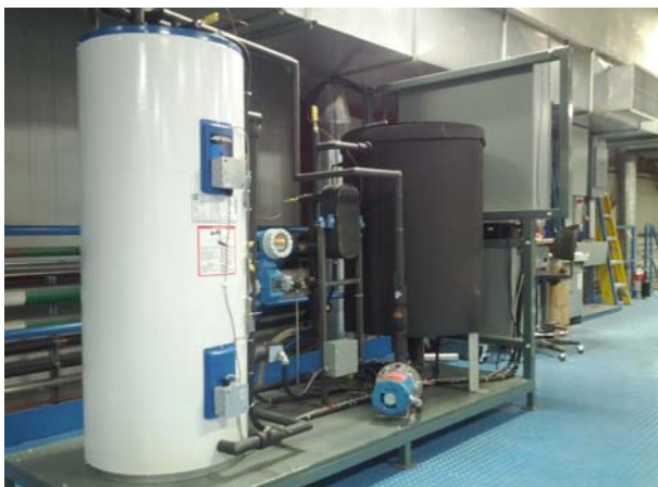
Figure 2 : Banc d'essai de la solution de réponse à la demande avec un chauffe-eau électrique
